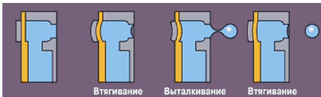
Рис. 3. Принцип действия печатающей головки с пьезоэлектрическим управлением
